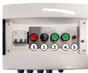
① Il selettor MAINTENANCE / NORMAL MODE consente di passare dalla modalità normale (NORMAL MODE) al funzionamento in manutenzione (MAINTENANCE) e viceversa; ogni volta che si passa dalla modalità di manutenzione a quella normale è necessario effettuare un reset tenendo premuti entrambi i pulsanti di salita e discesa per più di 3 secondi.
