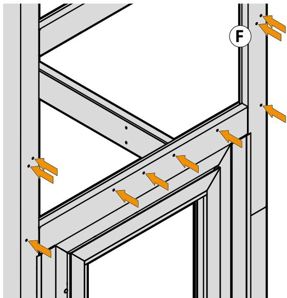
7. Siliconare accuratamente **G** la zona di contatto con la struttura.
