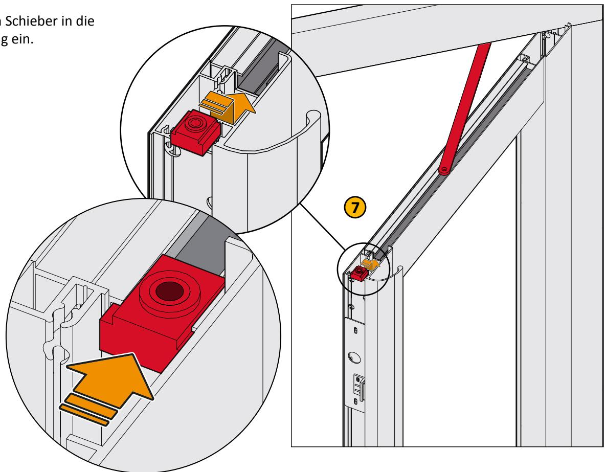
8 Befestigen Sie den Arm mit der mitgelieferten Schraube am Schieber und achten Sie darauf, die Buchse einzusetzen.
