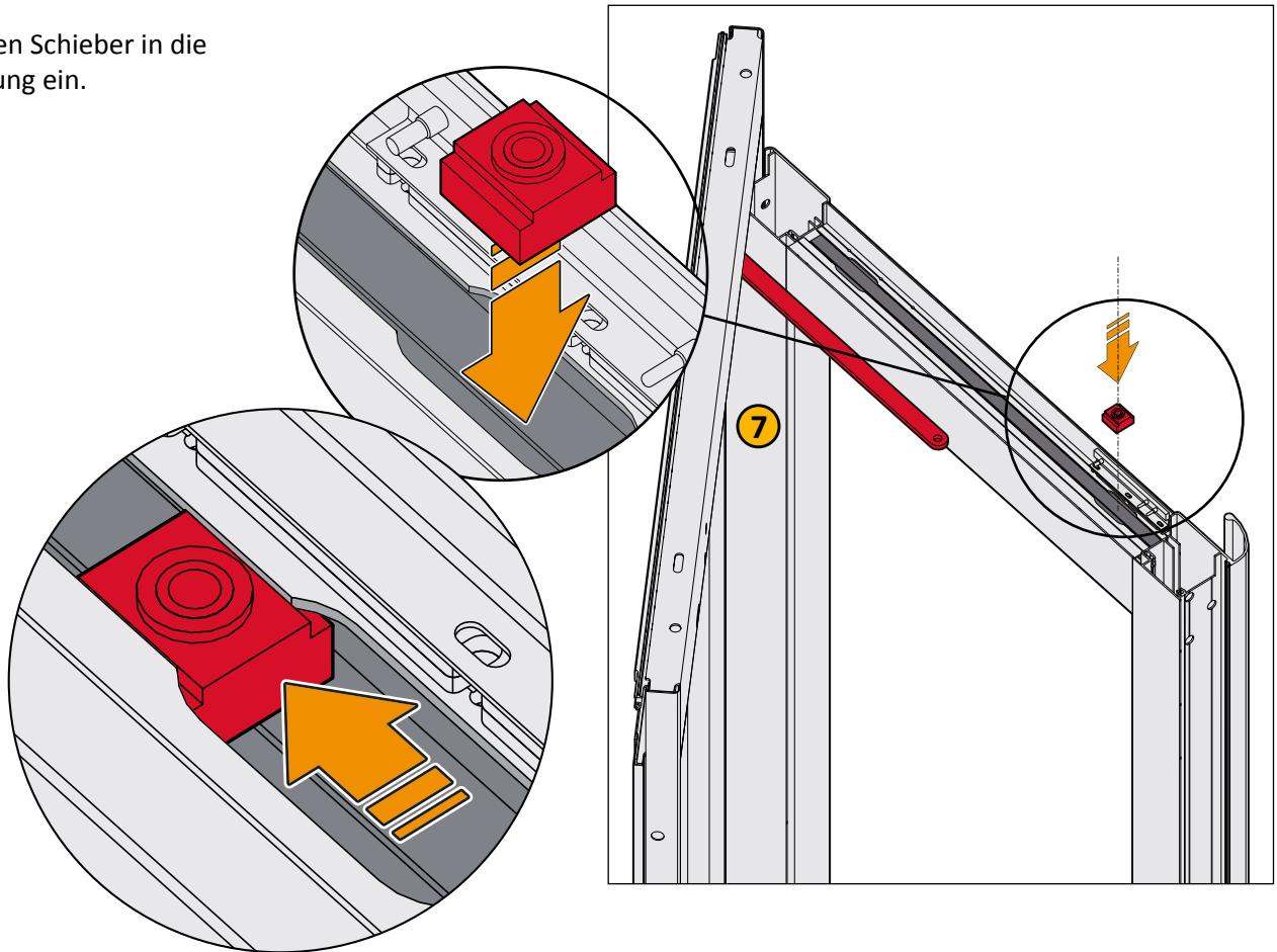
8 Befestigen Sie den Arm mit der mitgelieferten Schraube am Schieber und achten Sie darauf, die Buchse einzusetzen.
