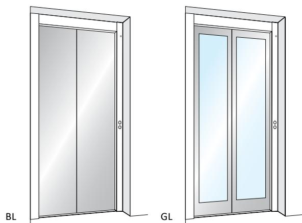
Porta di piano e di cabina a 2 ante scorrevoli centrali con **apertura e chiusura automatica**. Dotata di dispositivo di sicurezza che interrompe il movimento in caso di ostacolo.
