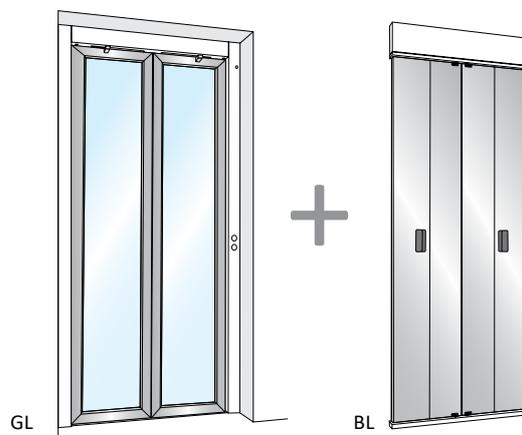
Porta a soffietto in cabina ad **apertura e chiusura completamente automatica** abbinata a porta di piano a due battenti. Dotata di dispositivo di sicurezza che interrompe il movimento in caso di ostacolo.
