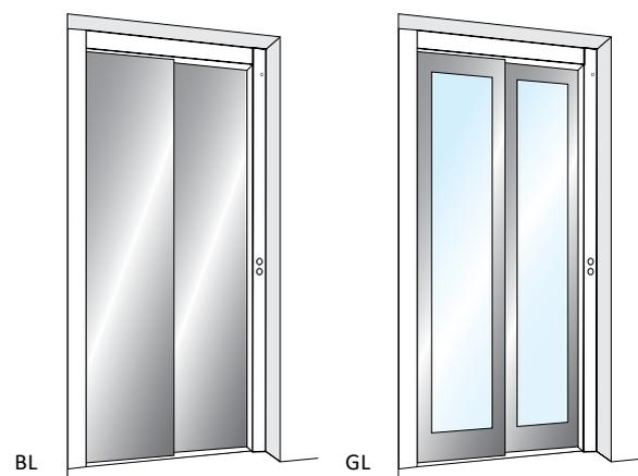
Porta di piano e di cabina a 2 ante scorrevoli laterali con **apertura e chiusura automatica**. Dotata di dispositivo di sicurezza che interrompe il movimento in caso di ostacolo.
